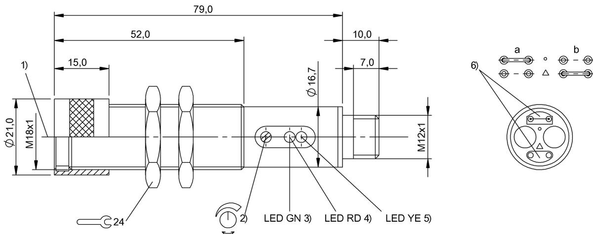
1) Eje óptico, 2) Sn, 3) Estabilidad, 4) Error, 5) Recepción de luz, 6) a= claro / b= oscuro
