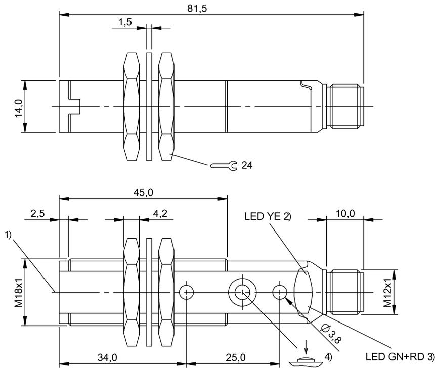
1) Eje óptico, 2) Función de salida, 3) Estabilidad/error, 4) Sn
