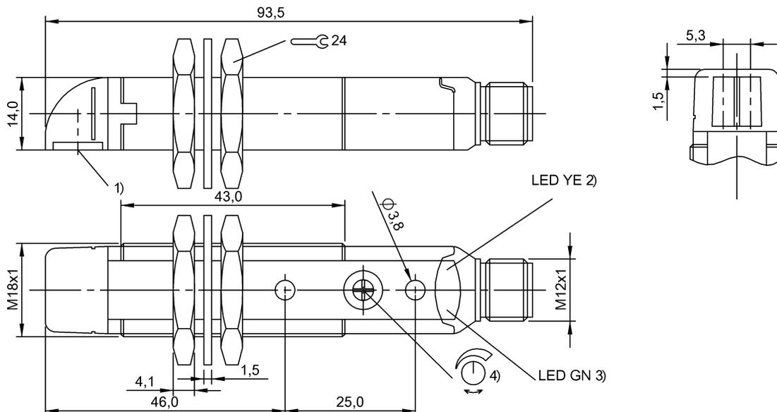
1) Eje óptico, 2) Función de salida, 3) Estabilidad, 4) Sn
