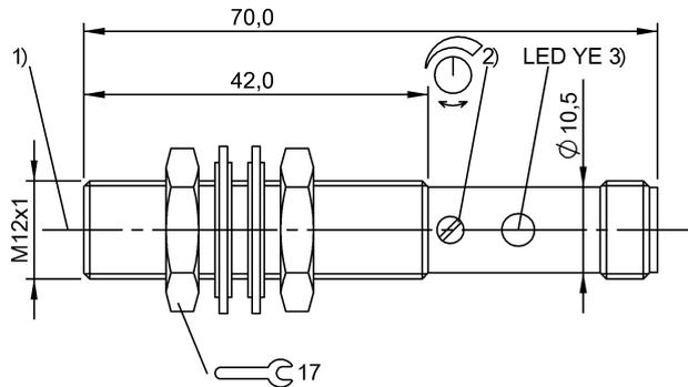
1) Eje óptico, 2) Sn, 3) Función de salida
