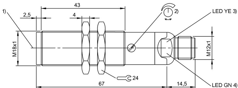
1) Eje óptico, 2) Sn, 3) Función de salida, 4) Estabilidad
