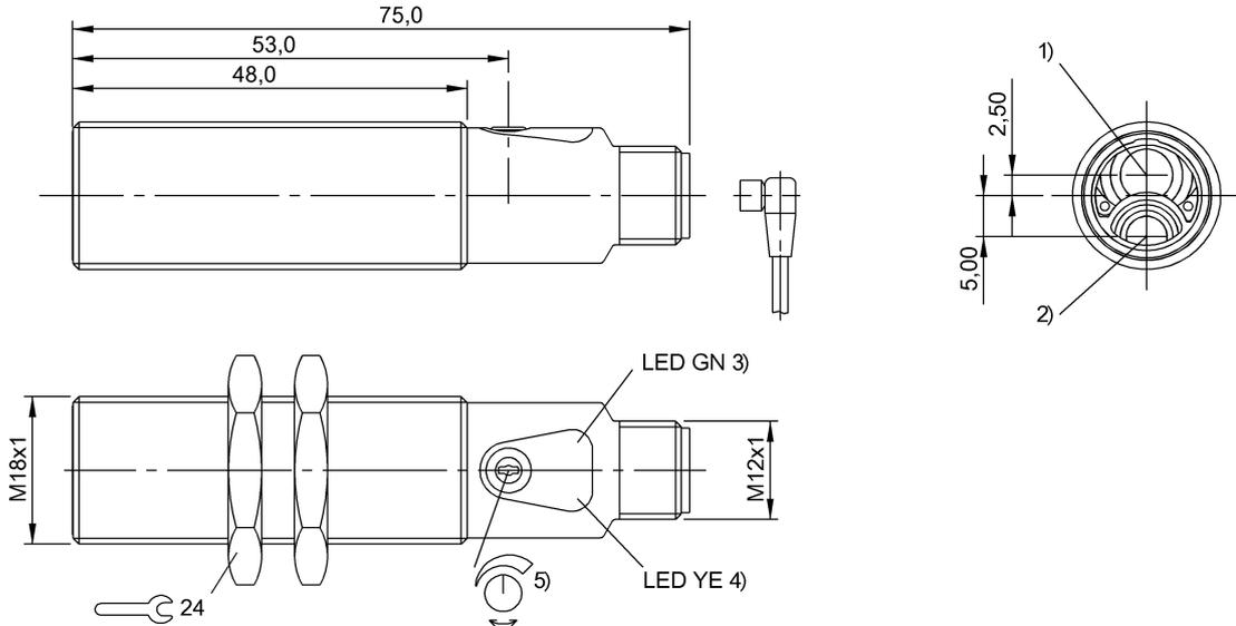
1) Eje óptico de receptor, 2) Eje óptico de emisor, 3) Tensión serv./cortocircuito, 4) Función de salida/error, 5) Sn
