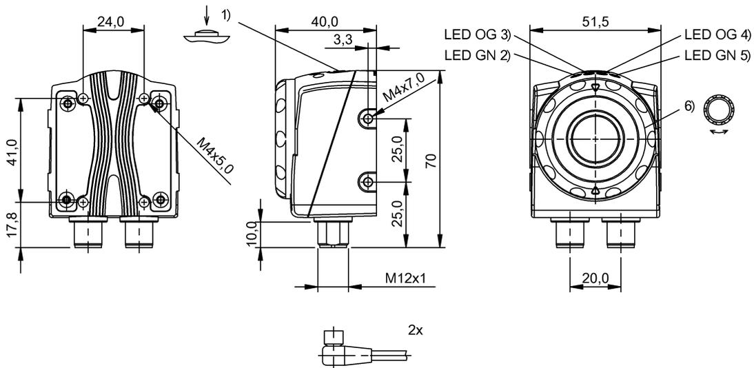
1) Programación imagen de referencia, 2) Tensión de servicio, 3) Salida 1 activa, 4) Salida 2 activa, 5) Conexión con PC, 6) Nitidez de la imagen
