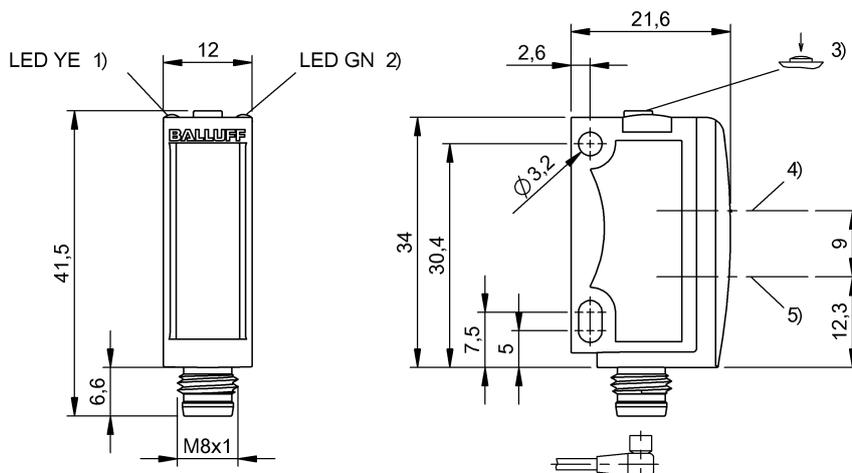
1) Función de salida, 2) Tensión de servicio, 3) Sn, claro/oscuro, 4) Eje óptico de receptor, 5) Eje óptico de emisor
