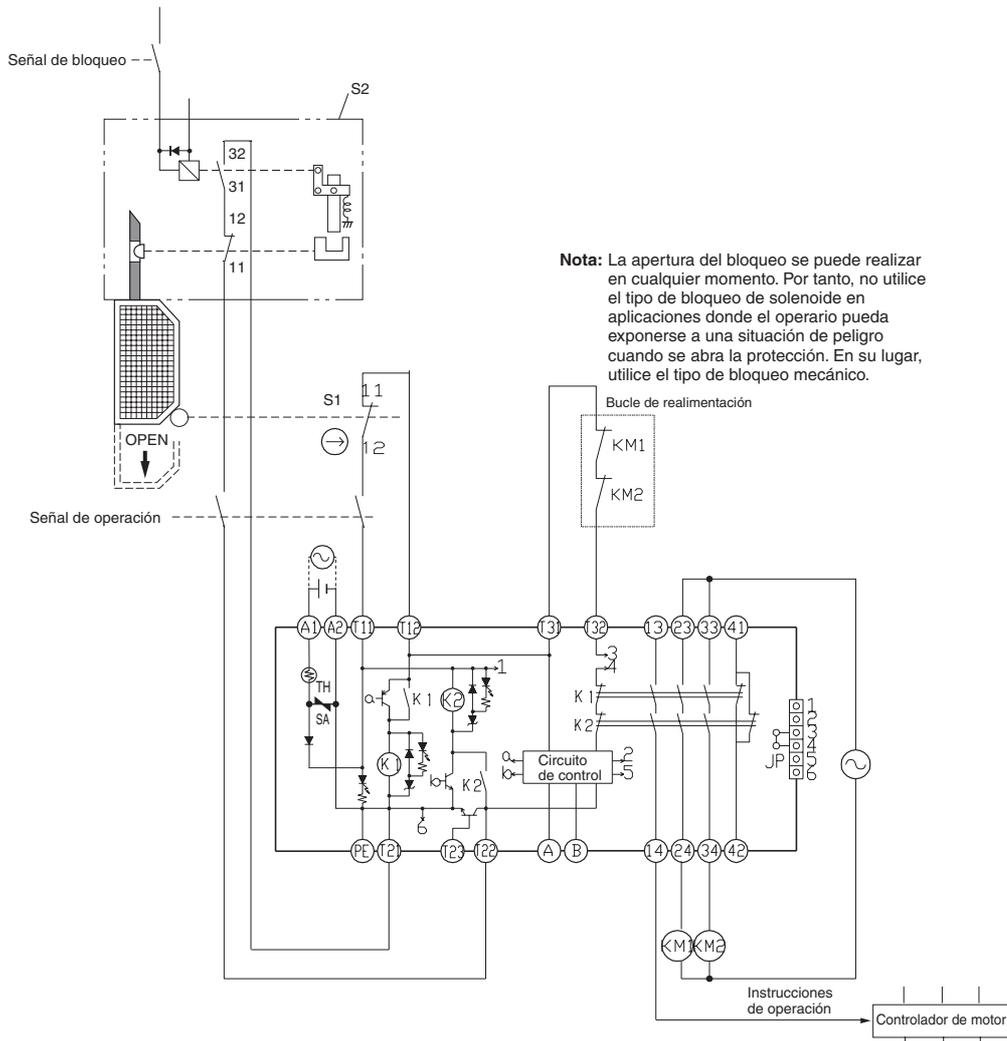
**Nota:** La apertura del bloqueo se puede realizar en cualquier momento. Por tanto, no utilice el tipo de bloqueo de solenoide en aplicaciones donde el operario pueda exponerse a una situación de peligro cuando se abra la protección. En su lugar, utilice el tipo de bloqueo mecánico.
