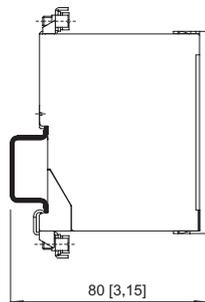
Montado en rail de montaje DIN NS 35/15
