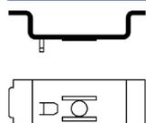
El adaptador permite montar una barrera de seguridad intrínseca en el pie de sujeción (n.º-art. 165283) o en una placa de montaje de una serie anterior.
