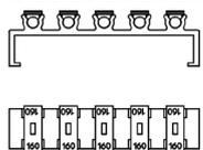
El portafusibles se engancha con clips en el lateral de una barrera de seguridad intrínseca y puede equiparse con hasta 5 fusibles previos (repuesto).
