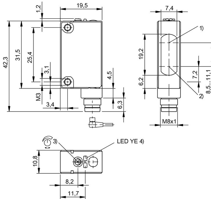
1) Eje óptico de receptor, 2) Eje óptico de emisor, 3) Sn, 4) Función de salida
