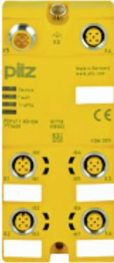
Módulo de entrada descentralizado para PNOZmulti, grado de protección IP67, conexión a través de módulo de conexión, 8 entradas digitales seguras, 8 salidas configurables para automatización, tacto de prueba o 24 V.
