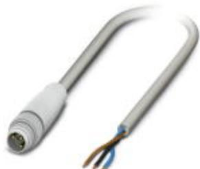
Cable para sensores/actuadores, 3-polos, PP-EPDM sin halógenos, gris RAL 7035, Conector macho recto M8, a extremo de cable libre, longitud de cable: 10 m, Diseño higiénico, con moleteado de plástico
