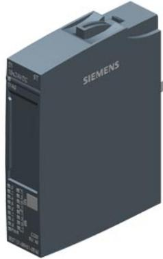
SIMATIC ET 200SP, módulo de entradas digitales, DI 16x 24V DC Standard, tipo de entrada 3 (CEI 61131), Sink Input, (PNP, tipo p), embalaje 1 pieza, apto para tipo de UB A0, código de color CC00, retardo de entrada 0,05..20ms; diagnóstico de módulo para: rotura hilo, tensión de alimentación
