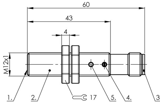
1) Superficie activa, 2) Carcasa, 3) Tapa, 4) Potenciómetro, 5) LED de indicación de función
